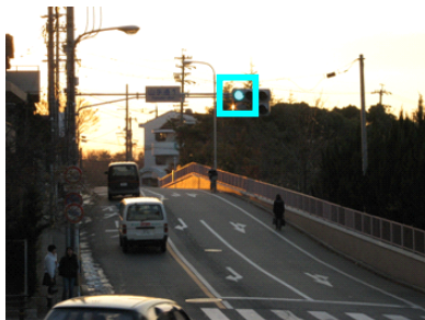
図 6 昼画像の実験結果例 (円形度 0.7, 類似度 1.0)
