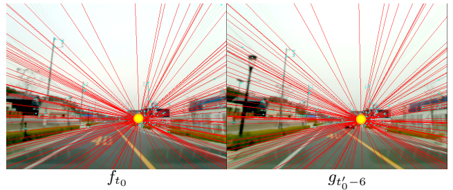
2 カメラ間の距離大 2 カメラ間の距離中 2 カメラ間の距離小 図 4 2 カメラの位置とエピポールの位置の関係
